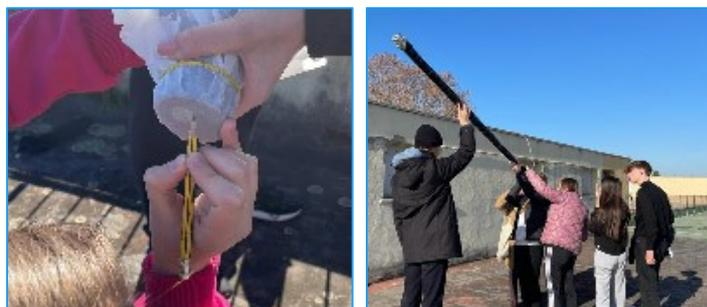
Per ridurre gli errori di misura, abbiamo deciso di fare più misurazioni del diametro delle ombre per avere risultati più attendibili, standardizzando il risultato: abbiamo ripetuto ogni misura dell'ombra, per ogni tubo, 10 volte e, come diametro dell'ombra, nei nostri calcoli, abbiamo usato la misura attendibile, cioè la media aritmetica delle misure che abbiamo ottenuto.
